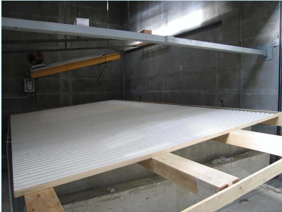
Fotografia del campione, lato camera emittente. Photograph of sample, source room side.
